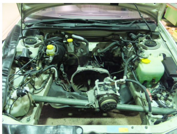
エンジンを抜き取った状態のボンネット部分
